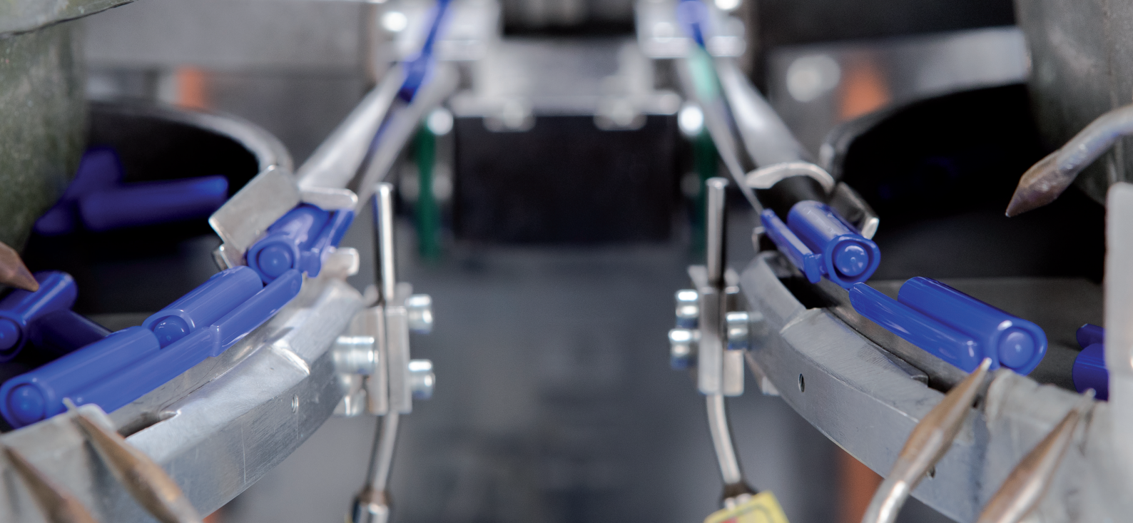
Zuführen Schoner zur Montagelinie; Bild: STAEDTLER
