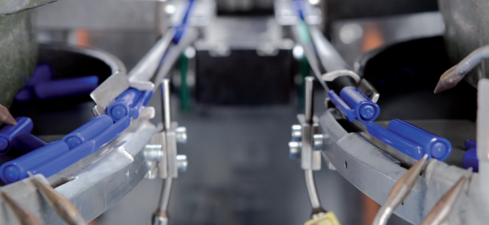
Zuführen Schoner zur Montagelinie; Bild: STAEDTLER
